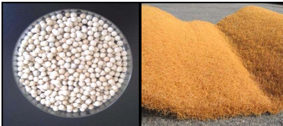
شکل ۱- تصویر الیاف ژئولیت نقره (سمت راست) و گرانول ژئولیت نقره (سمت چپ) مورد استفاده در سیستم فیلتراسیون آب.
